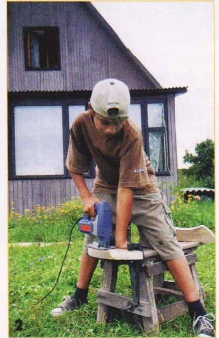
Для удобства работы заготовку будущей ножки следует зажать струбциной.
